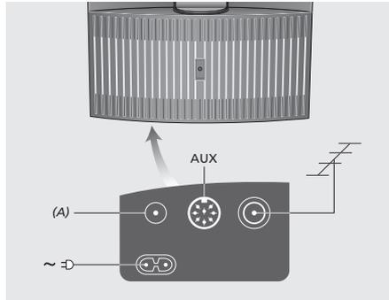
插座板位于 BeoSound 1 的底部。插座板上有电源、天线及 AUX(辅助设备)插座。
